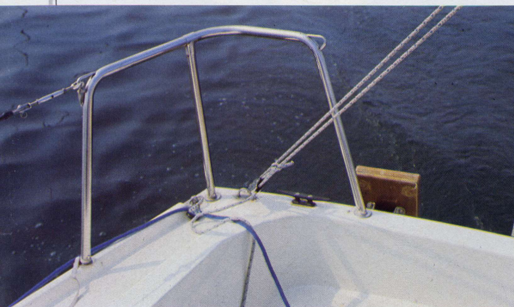
Il Tyl 23 non ha volanti. Nella foto vediamo uno dei due bozzelli che compongono il sistema di regolazione del paterazzo; quello di destra (guardando la prua) regola la tensione.
